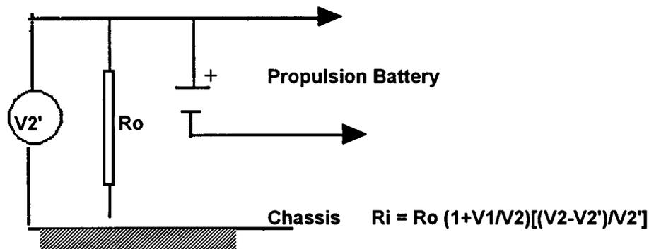
Fig. 5 S7.7.7 MEASUREMENT LOCATION FOR  $V_2'$  VOLTAGE
